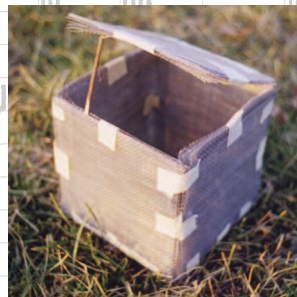
Akkumulator aus PE-Folie und Stahldrahtgewebe
